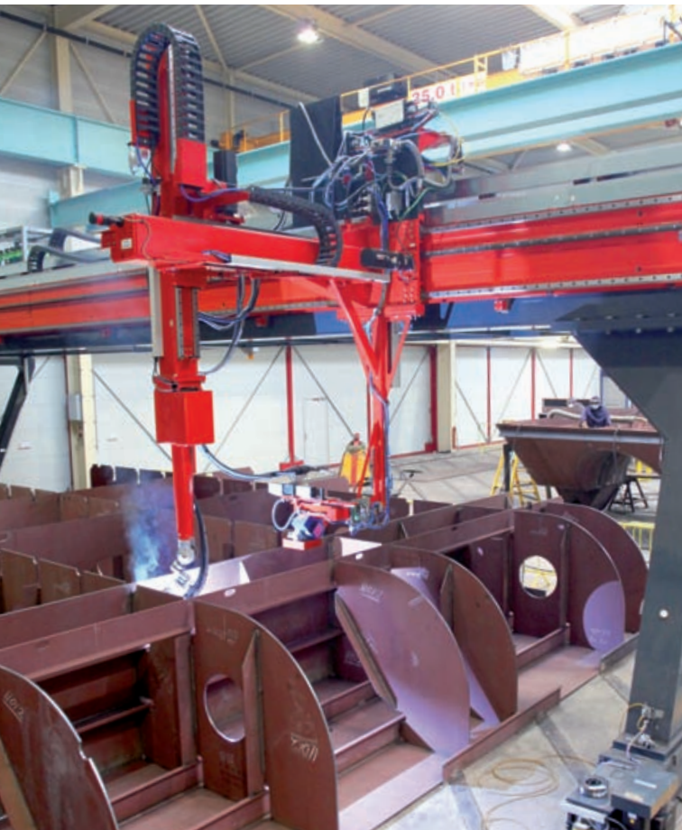
Das neue Brückenportal erlaubt das Schweißen von Sektionen mit einer Grundfläche von etwa 12 x 12 m
